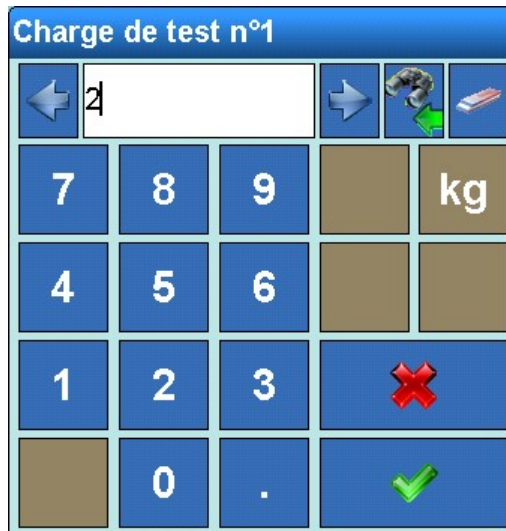
Figure 3-22 : Entrée du poids test n° 1
