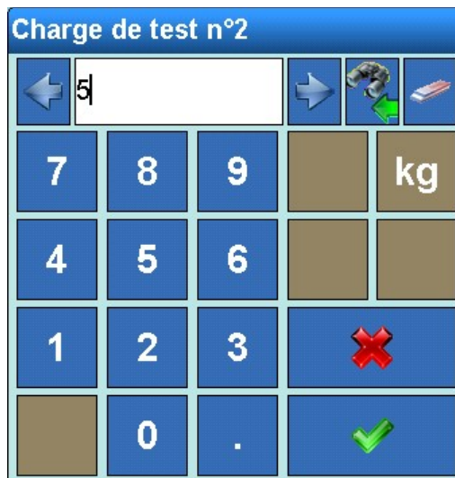
Figure 3-23 : Entrée du Poids test n° 2
