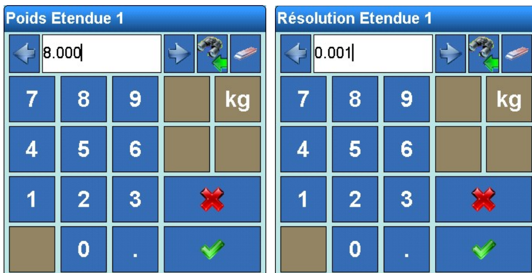
Figure 3-17 : Entrée de la capacité et de l'échelon
